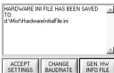
Über den Button **GEN. HW INFO FILE** wird ein File erzeugt, in dem alle wichtigen Sensordaten verschlüsselt hinterlegt werden. Dieses File kann zu Diagnosezwecke an den Hersteller gesendet werden.
